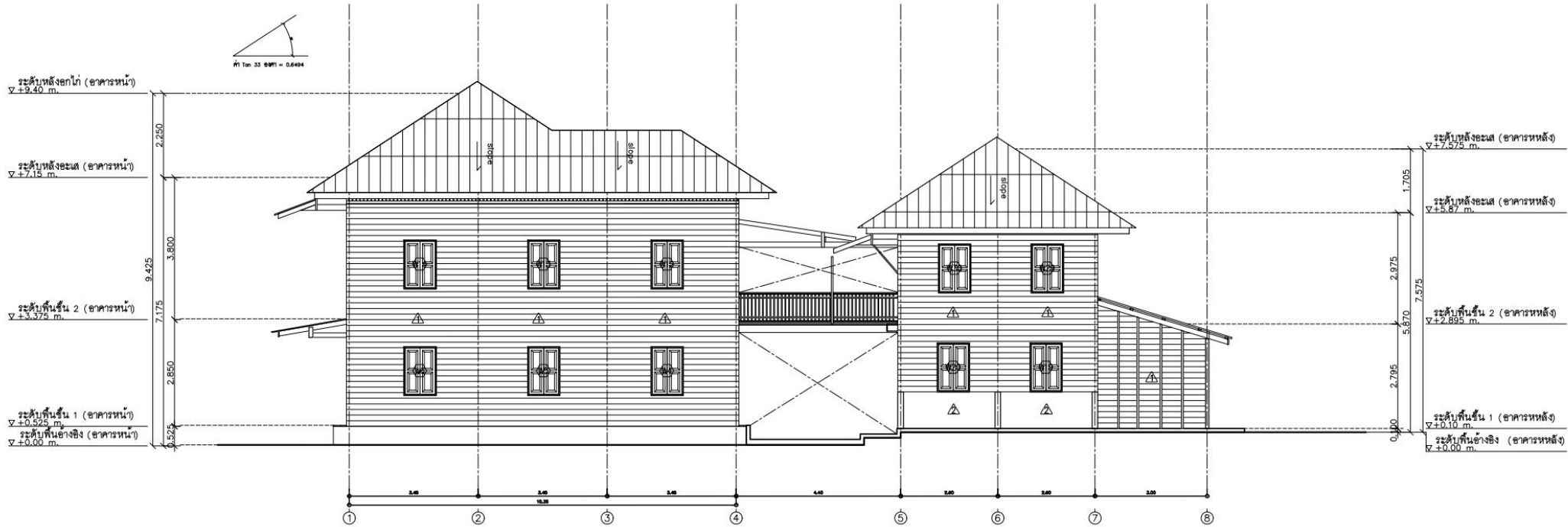
รูปด้าน D อาคารด้านหน้า ด้านหลัง และทางเชื่อม มาตรฐาน 1:125
